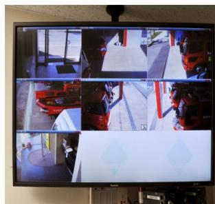
署所の屋内外に設置した情報カメラの映像を指令室表示盤に動画にて表示します。
