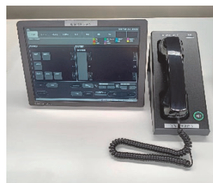
無線統制台 (遠隔制御装置)
